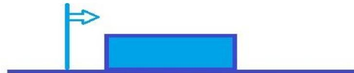
Импульсная ионизация потока за плоской ударной волной после ее дифракции на задней стенке препятствия
